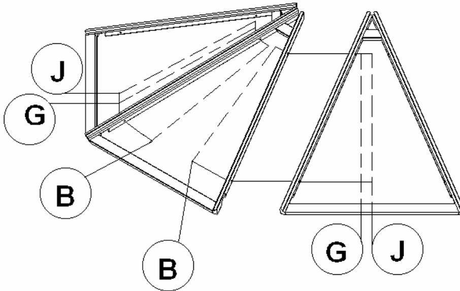
Montieren Sie zunächst die Stirnseiten des Daches (wie oben gezeigt) am Boden vor. Ziehen Sie dabei die Schrauben noch nicht fest an. Setzen Sie dann die vormontierten Elemente auf die Wände und schrauben dann die Mittelelemente dazwischen. Zum Schluss können Sie alle Schrauben anziehen (mit Gefühl!).
